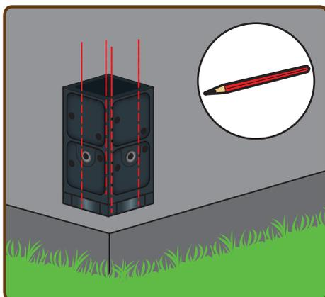
**2** Marquer au crayon par exemple les 4 trous à percer.
