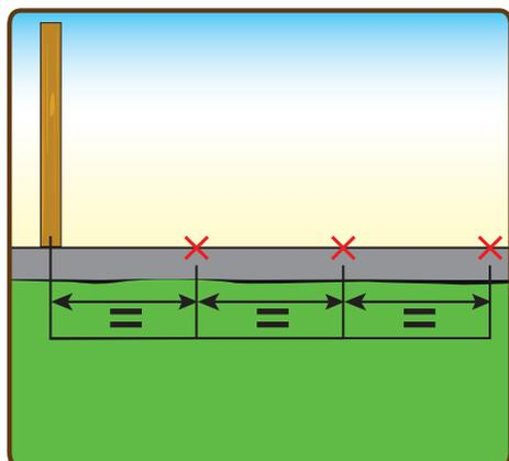
**1** Tracer la clôture à l'aide d'une corde par exemple. Déterminer l'emplacement des supports (fonction de la largeur des panneaux).
