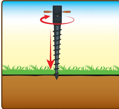
**2** Commencer à visser le support à l'aide de 2 tournevis ou de 2 barres métalliques en passant par les trous prévus pour les vis.
